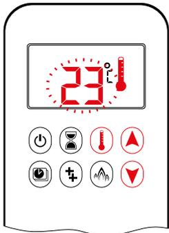
**NOTE:** La température réglée en Mode Thermostatique correspond à la température en heure de **MARCHE** du Mode Programme. Le changement de température réglée en Mode Thermostatique change également la température d'heure de **MARCHE** du Mode Programme.
