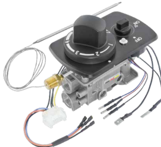
◀ GV30A (thermostatgesteuert) mit Kontroll-LED, Blende, großem Temperatureinstellknopf, sowie Modul für die elektronische Zündung und Anzeige der aktivierten Zündflamme mittels LED
