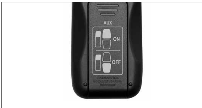
Abb. 22: Anleitung für bistabiles Magnetventil auf Batteriefachdeckel
